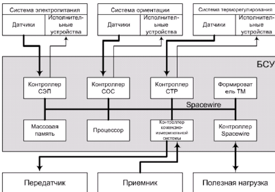
Рис. 2. Предполагаемая архитектура распределенной бортовой системы управления КА
