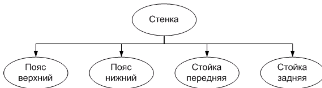
Рис. 5. Пример графа сборки по конструкторским базам
