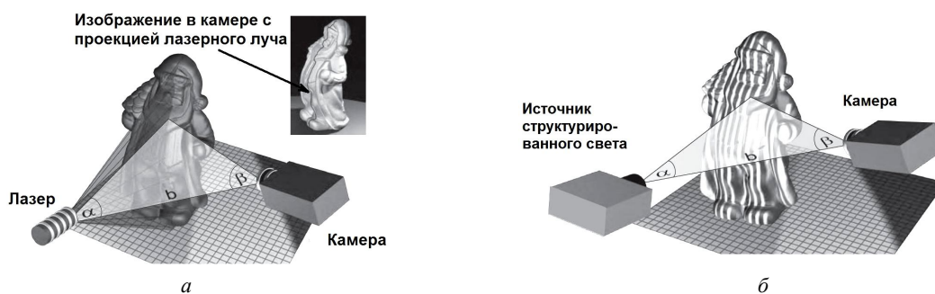
Рис. 2. Принцип работы лазерного сканирования (а) и сканирования с применением источника структурированного света (б)
