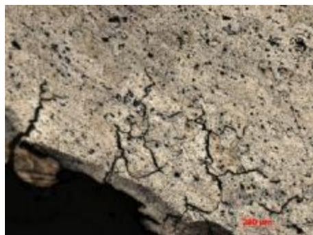
Рис. 4. Труба алюминиевая (продольный разрез): I = 50 А
