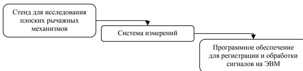
Рис. 3. Основные элементы аппаратно-программного комплекса для исследования плоских рычажных механизмов
