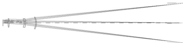
Рис. 3. Схема прямого фокуса с параболическим главным зеркалом диаметром 0,2 метра и предфокальным трехлинзовым корректором
