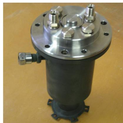
Рис. 5. Камера сгорания и головка двигателя ДМТ МАИ-500ВПВК
