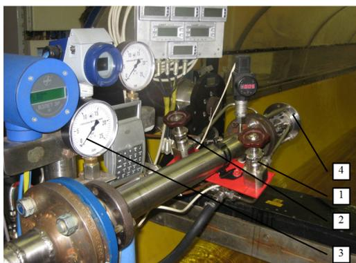
Рис. 6. Испытания распыла головки двигателя ДМТ МАИ-500 на анализаторе Malvern Spraytec: 1 – вентиль подачи О; 2 – вентиль подачи Г; 3 – система измерения давления в магистралях подачи и расходов; 4 – закрепленная смесительная головка
