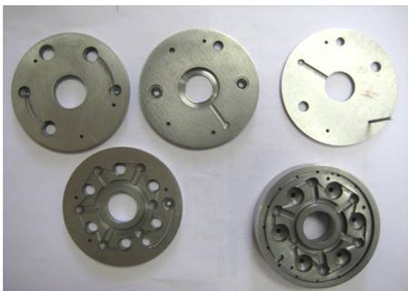
Рис. 4. Набор пластин для форсуночной головки
