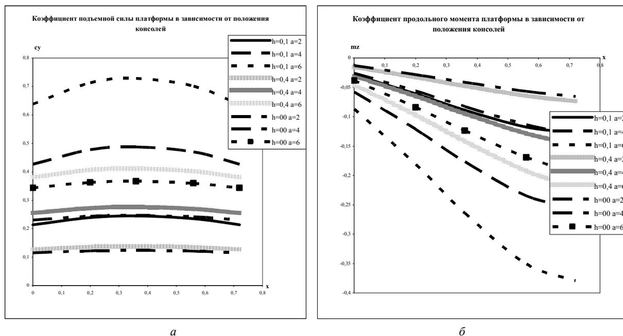
Рис. 7: а –  $c_y = f(\alpha, h, \bar{x}_k)$  платформы без шайб; б –  $m_z = f(\alpha, h, \bar{x}_k)$  платформы без шайб
