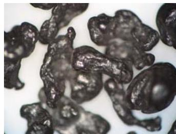
Рис. 3. Оптическая фотография алюминиевого порошка ( $\times 50$ )
