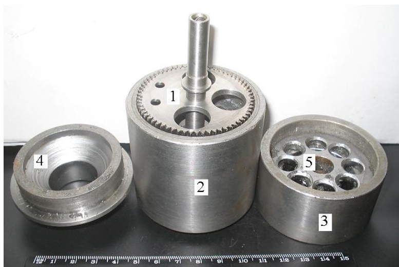
Рис. 5. Приспособление для АЭО зубчатого венца шестеренки
