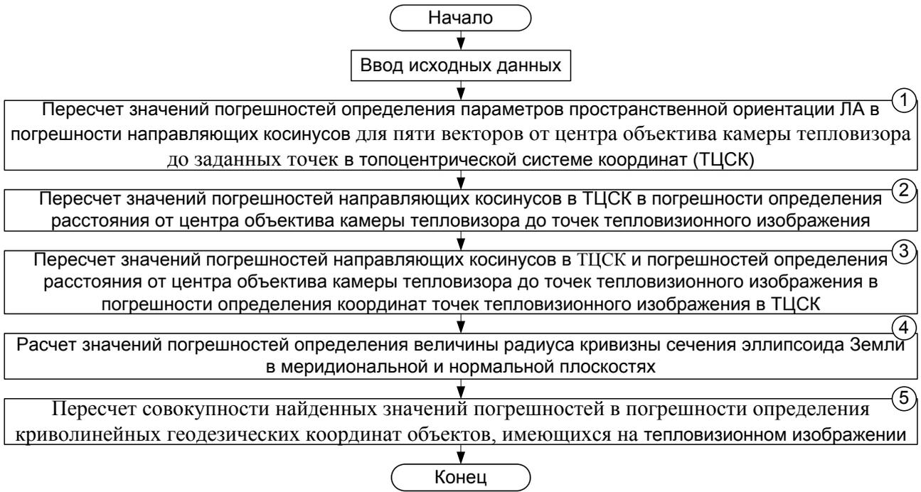
Рис. 3. Блок-схема алгоритма расчета погрешностей определения координат объектов, имеющих на тепловизионном изображении
