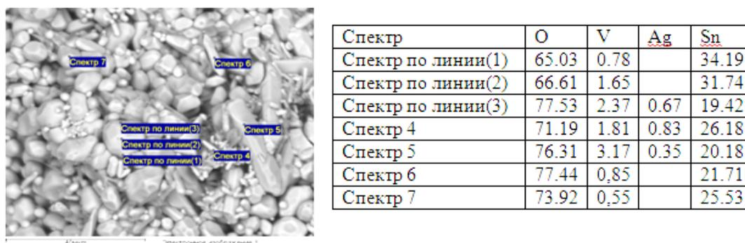
Рис. 4. Излом керамики состава SnO<sub>2</sub> – 96 %, V<sub>2</sub>O<sub>5</sub> – 2 %, AgO – 2 % и результаты микрорентгеноспектрального анализа
