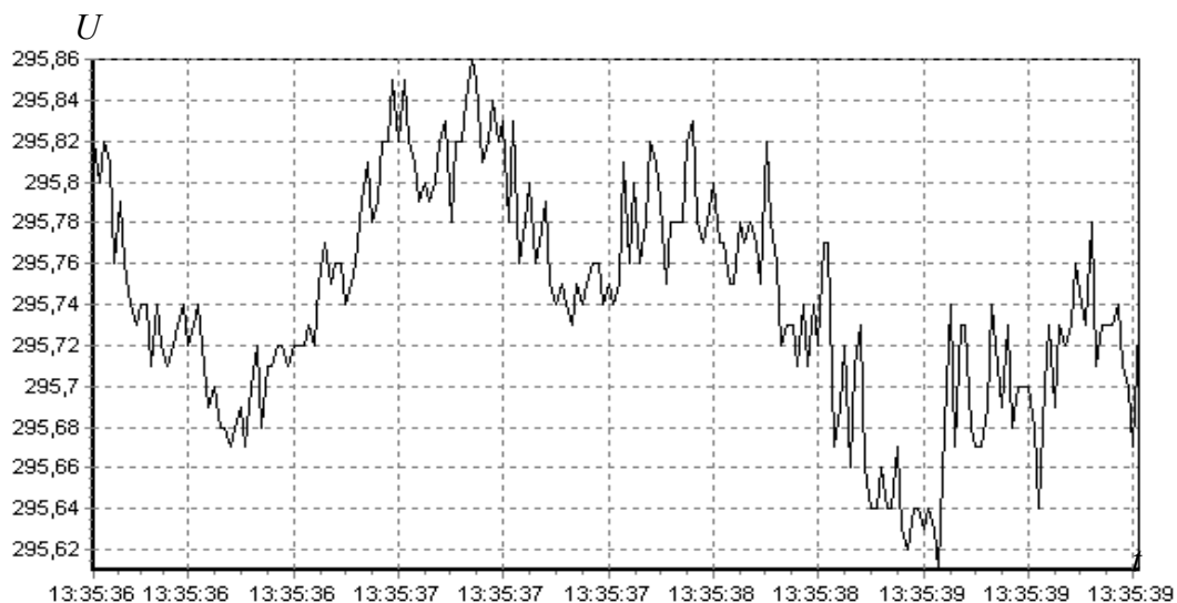
Рис. 5. Процесс изменения напряжения на Жигулевской ГЭС (200 значений) по состоянию на 12 января 2007 г.
