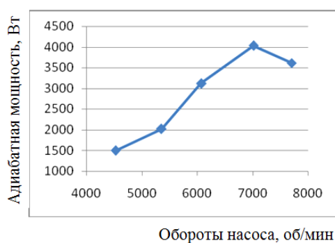
Рис. 4. Реакция ПТУ установки R22 на изменение оборотов насоса
