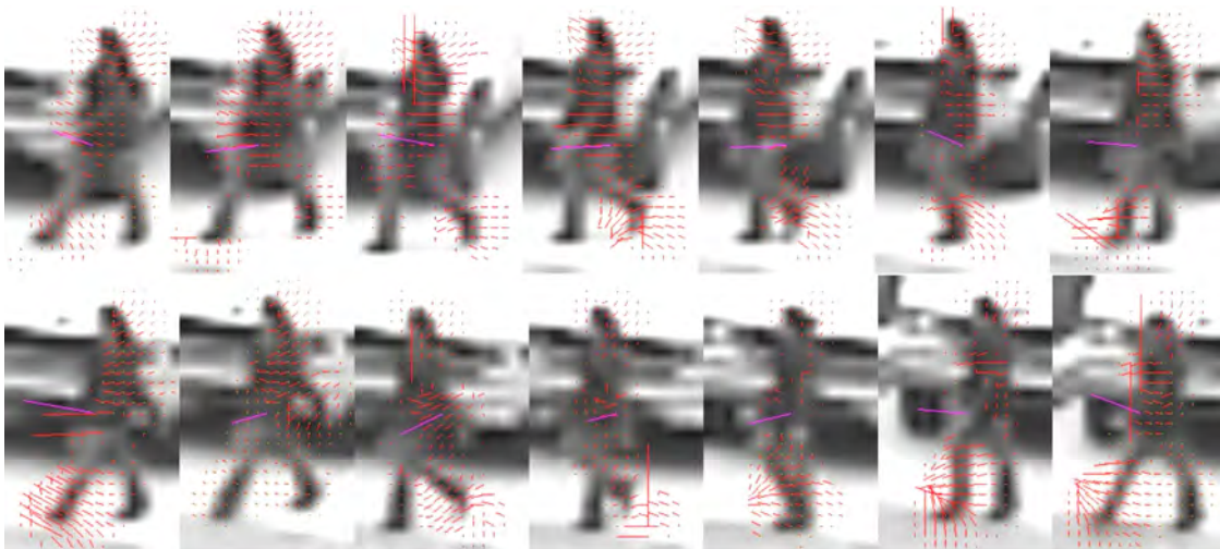
Рис. 2. Оптический поток объекта на кадрах с 2 по 30 с шагом 2
