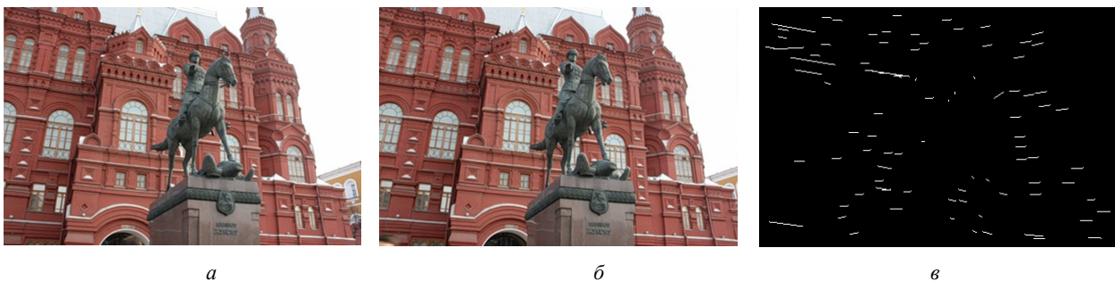
Рис. 2. Стереопара и построенное по ней векторное поле соответствий: а – левое изображение; б – правое изображение; в – поле соответствий
