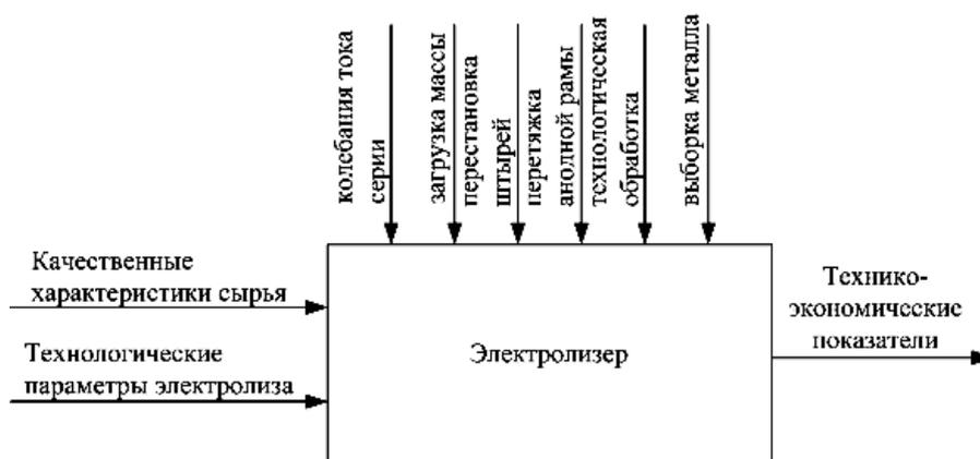
Рис. 1. Электролизер как объект управления
