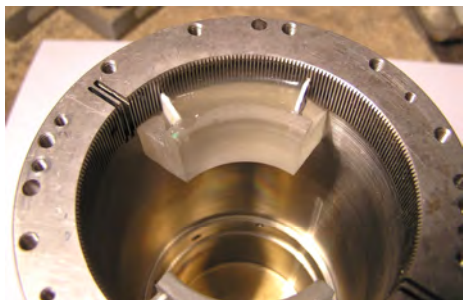
Рис. 4. Измерительное жесткое колесо ВЗП стенда КВЗП-01 (показан момент получения слепка с зубьев)
