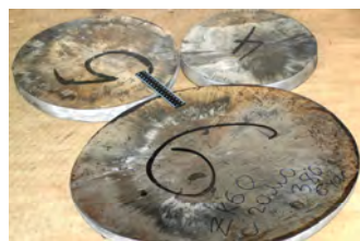
Рис. 6. Вид осажженных заготовок из сплава ZK60A на Ø 310 мм (№ 4), Ø 370 мм (№ 5), Ø 590 мм (№ 6)
