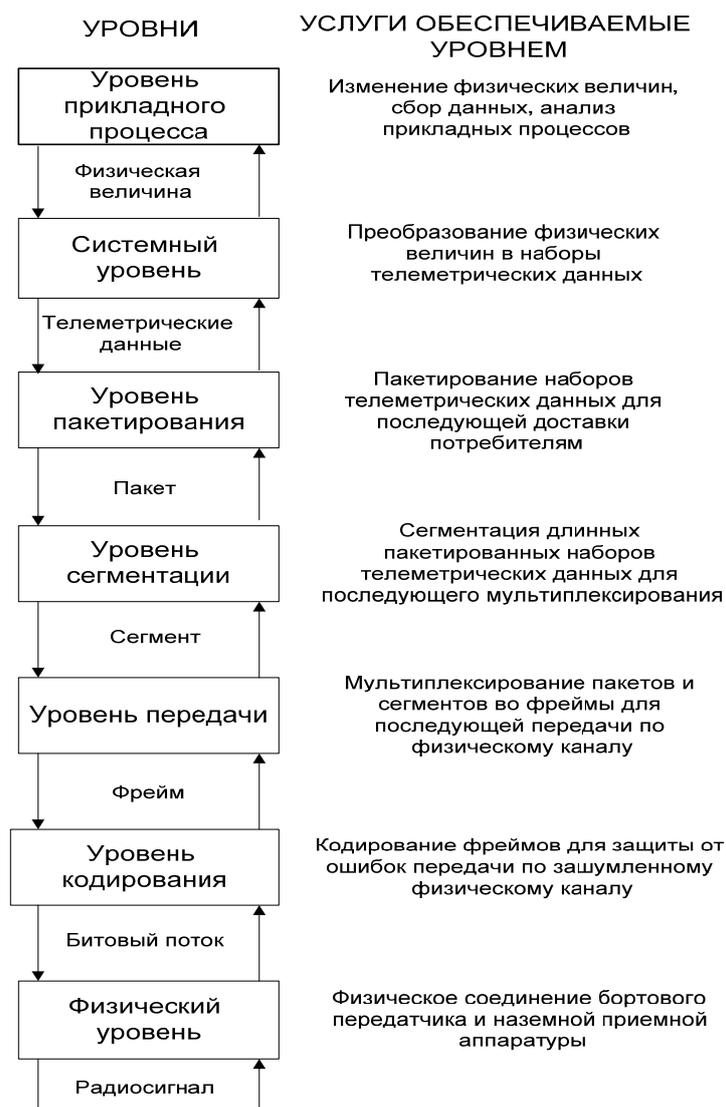
Рис. 1. Иерархическая модель телеметрических служб
