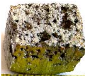
Рис. 4. Образец из пеноалюминия марки А7. Размер 40 × 35 × 35 мм
