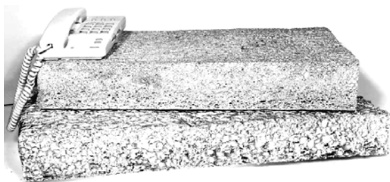
Рис. 1. Образцы пеноалюминия с разной плотностью и величиной ячеек, полученные с применением газовой инъекции (samples Hydro Aluminium, Norway)
