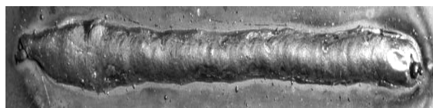
Рис. 4. Валик, наплавленный при V_{\text{п}} = 205 м/ч, I_{\text{д}} = 42,5 А, U_{\text{д}} = 24 В, V_{\text{св}} = 7,7 м/ч
