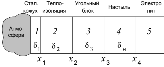
Рис. 2. Схема бортовой стенки
