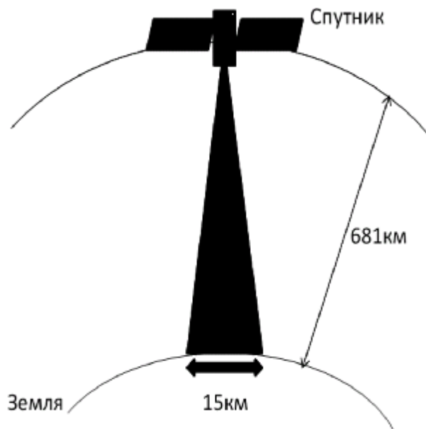
Рис. 2. Схема спутника GeoEye-1 с телескопом и его поле зрения
