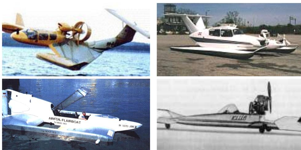
Рис. 1. Основные аэродинамические компоновки экранопланов
