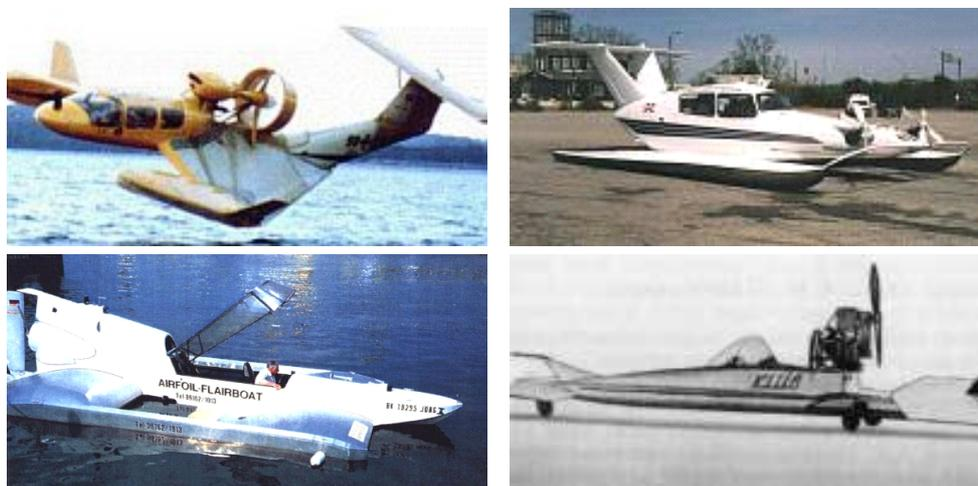
Рис. 1. Основные аэродинамические компоновки экранопланов
