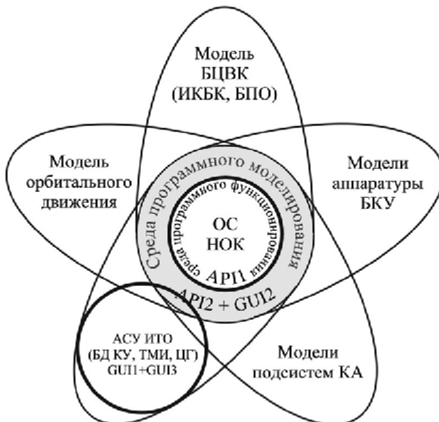
Рис. 2. Архитектура НОК БПО: БЦВК – бортовой цифровой вычислительный комплекс; ИКБК – интерпретатор команд бортового компьютера; БД КУ – база данных команд управления; ТМИ – телеметрическая информация; ЦГ – циклограммы испытаний; АСУ ИТО – АСУ испытаний и телеметрической обработки; GUI1 – штатный интерфейс; GUI2 – отладочный интерфейс; GUI3 – технологический интерфейс
