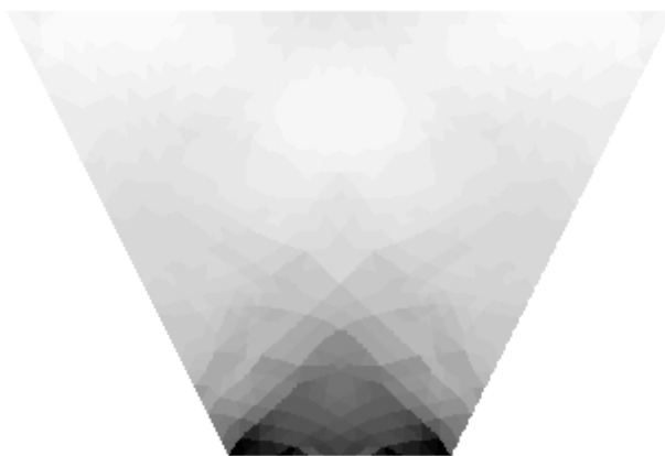
Рис. 2. Интенсивность деформации сдвига для задачи, приведенной на рис. 1 (обозначения см. в тексте)
