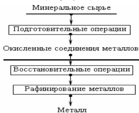
Рис. 1 Блок-схема технологий переработки минерального металлосодержащего сырья
