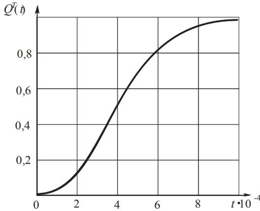
Рис. 3. Интегральная функция вероятности отказа тестовой системы с общим резервированием
