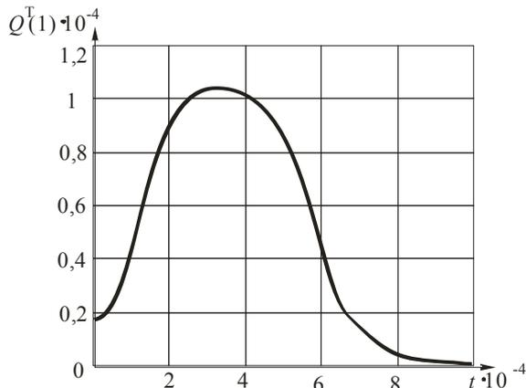
Рис. 4. Дифференциальная функция вероятности отказа тестовой системы с общим резервированием
