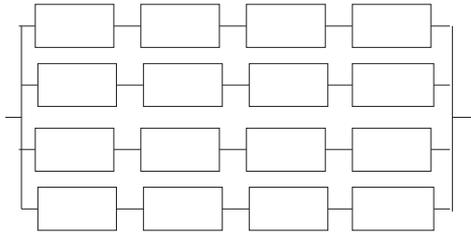
Рис. 2. Схема системы с общим резервированием
