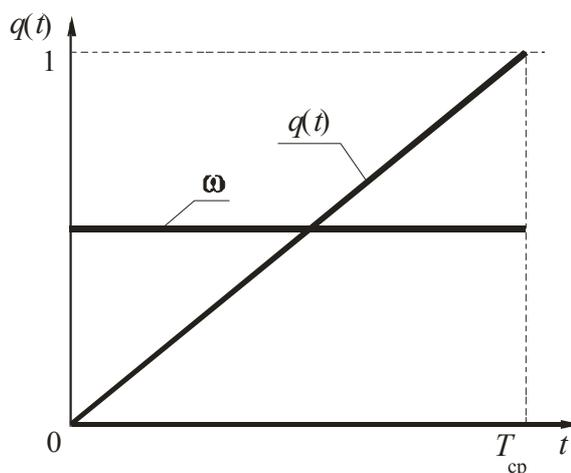
Рис. 1. Зависимость вероятности отказа и параметра потока отказов от времени при распределении с равномерной плотностью
