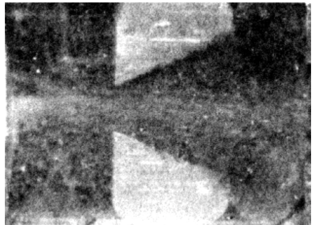
Рис. 6. Процесс течения в образце № 7 (конфузор)
