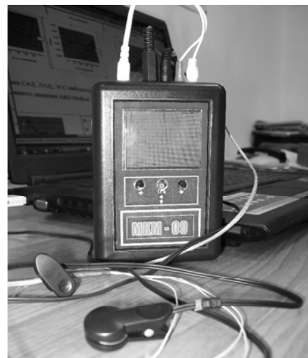
Рис. 1. Аппаратно-программный комплекс мониторинга функционального состояния организма человека на основе рекордера холтеровского типа МКМ-09
