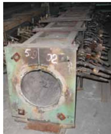
Рис. 4. Общий вид трехфазного индукционного нагревателя ИНМ-75
