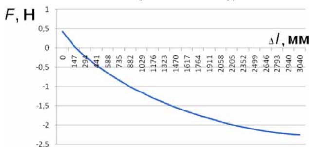
Рис. 4. Зависимость осевого усилия в стержне 2 от единичной вертикальной нагрузки
