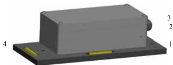
Рис. 5. Общий вид датчика 1 – плита опорная; 2 – корпус датчика; 3 – гермоввод; 4 – уровни установки датчика по горизонтали
