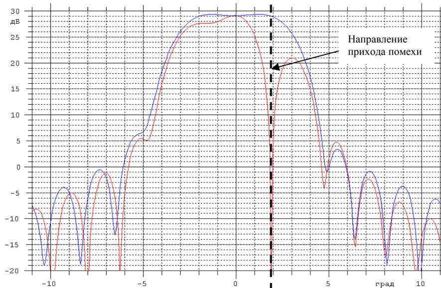
Рис. 3. ДН антенны до и после подавления сигнала в кластере
