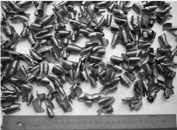
Рис. 11. Стружка, полученная при обработке винтовой поверхности радиусного профиля
