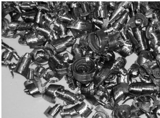
Рис. 12. Стружка, полученная при обработке винтовой поверхности конвольютного типа
