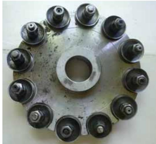
Рис. 8. Ротационная резцовая головка для обработки винтовой поверхности радиусного профиля
