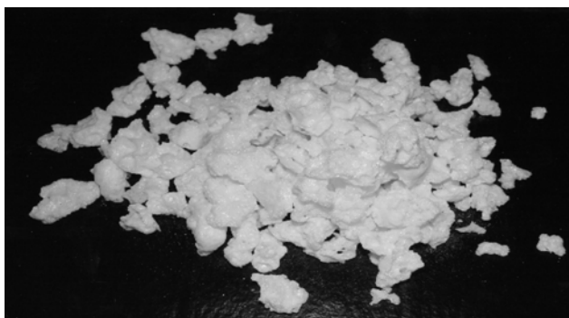
Рис. 2. Внешний вид пеносиликата (размер гранул от 2 до 20 мм)
