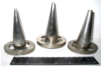
Рис. 6. Выравнивающие устройства, реализующие разную площадь сечения кольцевой щели
