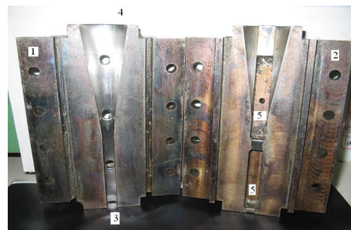
Рис. 5. Приспособление – имитатор сопла-насадки: 1 – крышка; 2 – основание; 3 – цилиндрическая часть канала; 4 – конусная часть канала; 5 – пазы для съемных образцов
