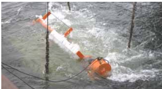
Рис. 6. Натурные испытания микроГЭС на Енисее
