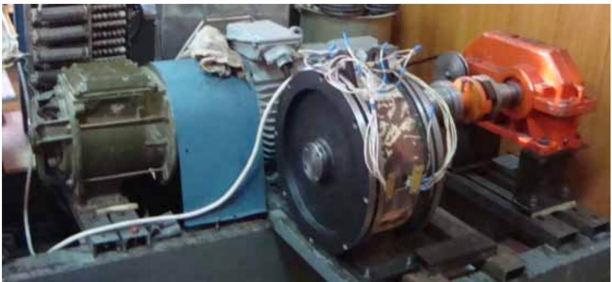
Рис. 5. Исследование на стенде характеристик НТСГ
