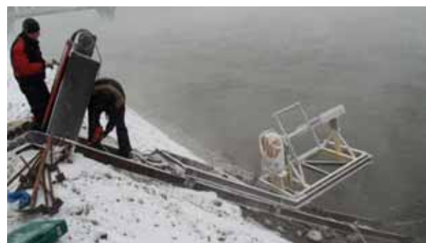
Рис. 6. Натурные испытания микроГЭС на Енисее
