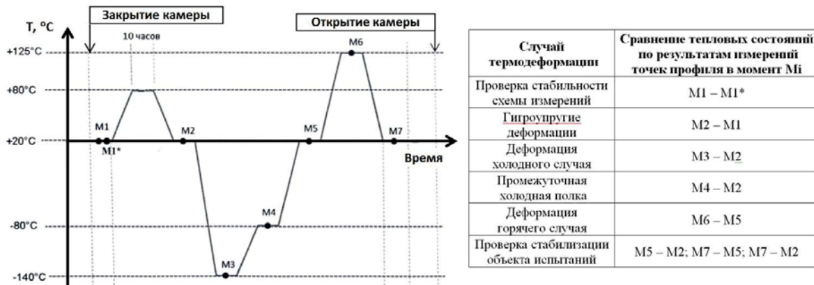
Рис. 6. Методика определения термдеформаций
