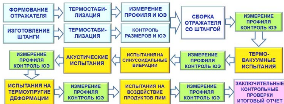
Рис. 4. Блок-схема НЭО рефлектора АС
