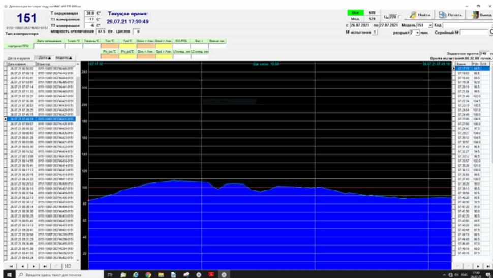
Рис. 2. График изменения активной мощности при подключении холодильника № 2 модели Б151 к сети питания
