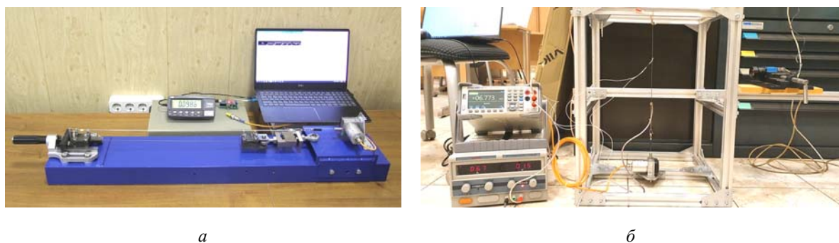
Рис. 2. Экспериментальные установки: а – для деформирования активных элементов; б – для определения основных характеристик активных элементов
