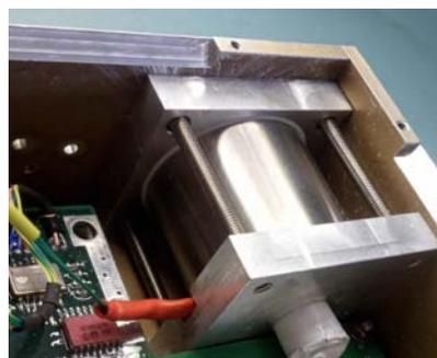
Рис. 4. Инверсно-магнетронный датчик
