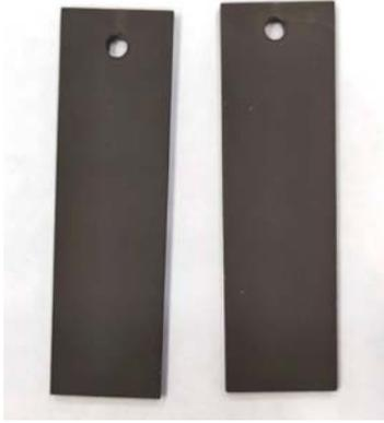
Рис. 2. Оксидированные образцы титанового сплава VT1-0
