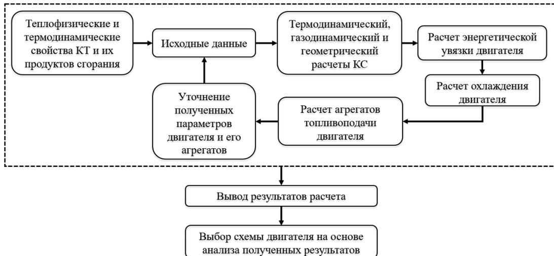
Рис. 5. Структурно-функциональная блок-схема квазистатической модели
