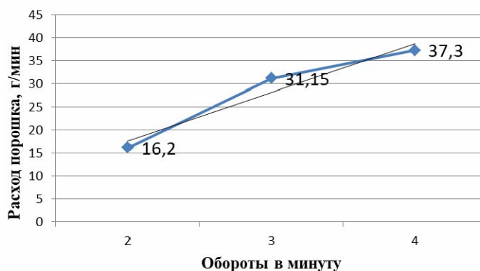
Рис. 2. График зависимости расхода порошка от частоты вращения диска
