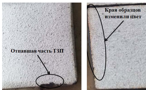
Рис. 4. Дефекты при испытаниях на жаропрочность
