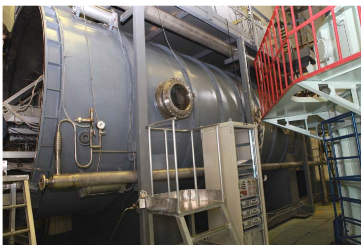
Рис. 11. Внешний вид вакуумной камеры стенда ГБУ-60
