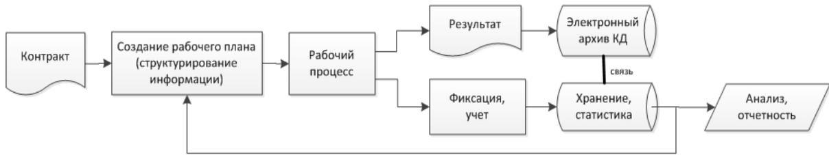
Рис. 5. Схема основного информационного потока в АСУП
