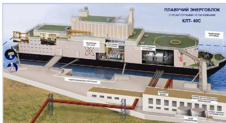
Рис. 13. Модель плавучей АСММ
