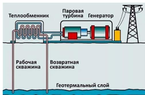
Рис. 12. Принципиальная схема использования геотермальных вод для производства электроэнергии
